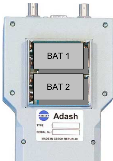
Obr. Pozice baterií bat 1 a bat2
