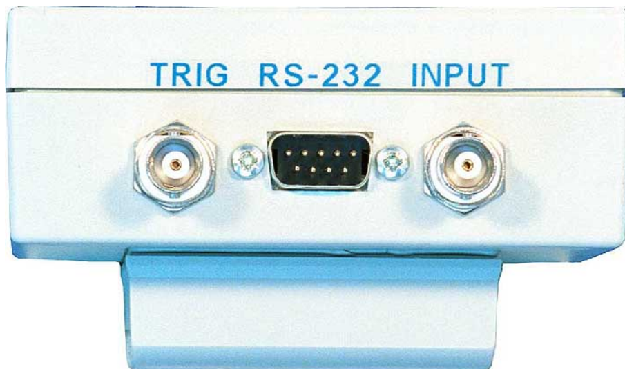
Obr. Připojovací konektory analyzátoru
