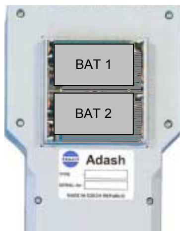
Obr. Umístění akumulátorů
